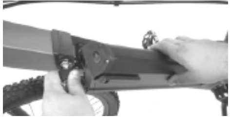
2) Schlüssel nach rechts drehen und halten! Akku seitlich einsetzen
