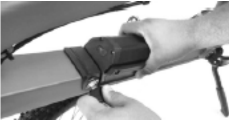
3) Während der Schlüssel nach rechts gehalten wird, Akku in die Halterung einrasten
